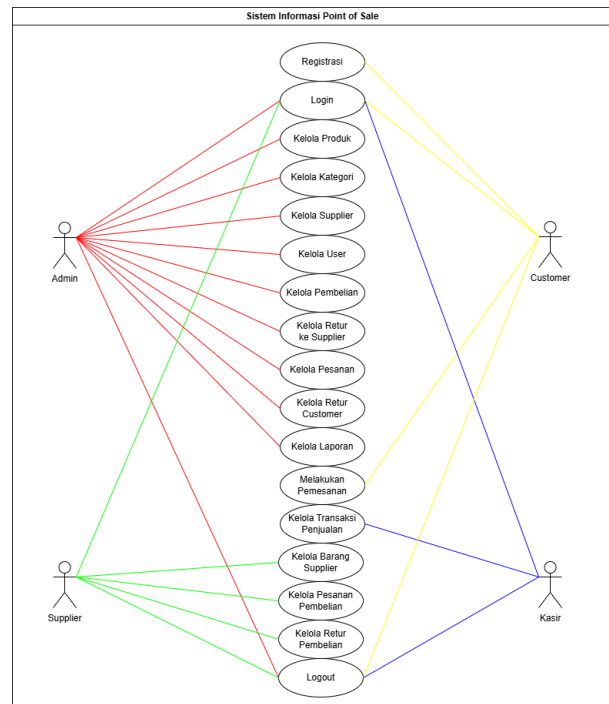
Gambar 2. Use Case Diagram Sistem Informasi POS D'Warung Sembako
